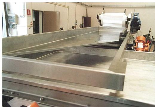
Si tratta di macchine dal funzionamento tranquillo e silenzioso. L'assenza di parti mobili accessibili le rende sicure. Idonee al trasporto di una vasta gamma di pezzature di prodotto, da particolari metallici relativamente pesanti sino alle polveri.
